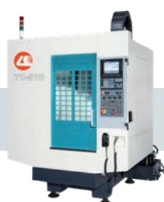
Centre de perçage taraudage
